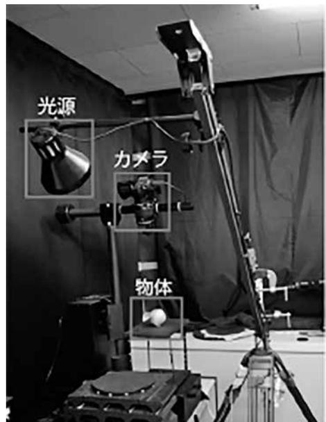
図2. 光反射特性計測系の概略図
