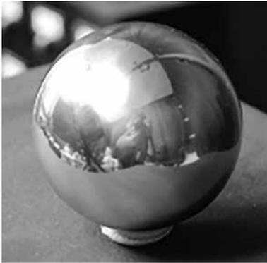
図3. 照明方向の推定に用いた鏡面球
