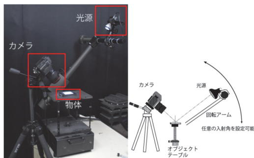
図2. 光反射特性計測系の概略図
