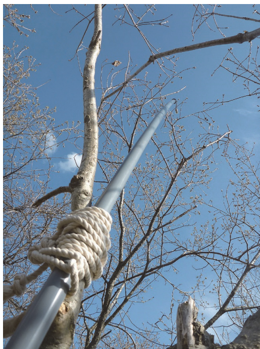
図-6 塩化ビニールパイプの支柱に先端に固定され樹冠外に設置された照度センサ (ミズナラ [地点B、個体No.4] [表-1]、上: 2013年5月5日撮影、下: 2012年5月13日撮影)
