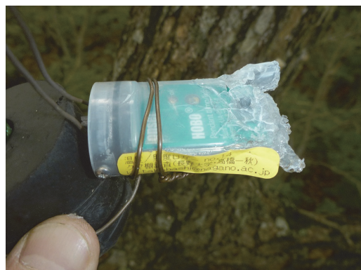
図-9 階層0.5mに設置した照度センサが動物にかじられ破壊された様子（ミズナラ〔地点B、個体No.4〕〔表-1〕、2014年6月29日撮影）
