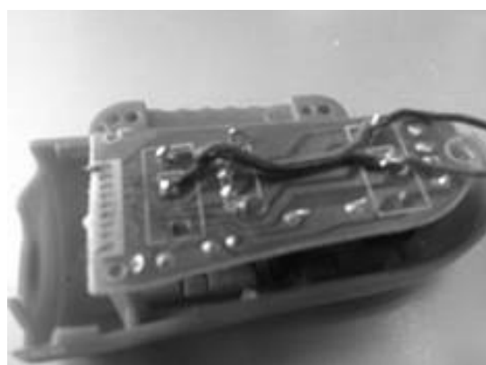
図6 指型マウス内部 改造後
